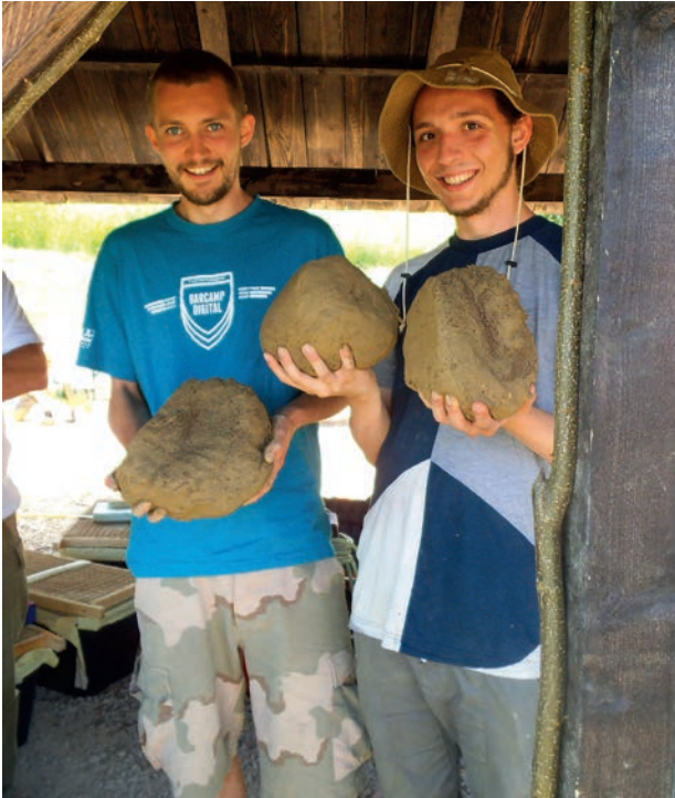
Abb. 99: Studenten mit sogenannten „Wuzeln“, dem Baustoff für (ungebrannte) Lehmmauern, während des experimentellen Nachbaus einer solchen Mauer in Niedersulz (Niederösterreich) im Rahmen einer Lehrveranstaltung der Universität für Bodenkultur Wien (fachliche Leitung: R. Meingast/LOPAS GmbH, H. Feiglstorfer/ÖAW, F. Ottner/BOKU; Foto: R. Meingast, Fototr. 1712a, Veröffentlichung mit freundlicher Genehmigung von R. Meingast).
