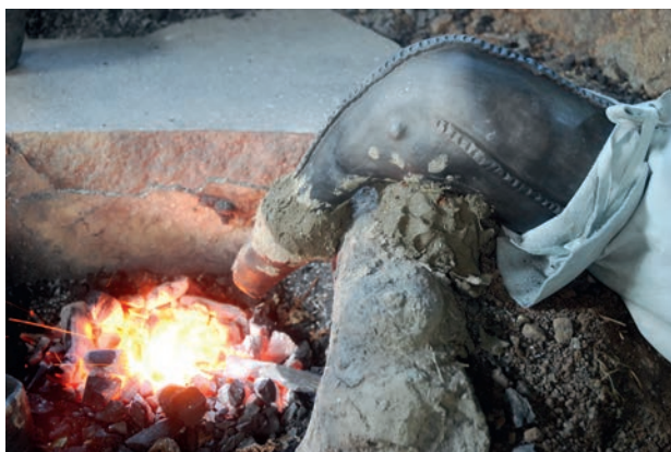
Abb. 116: Tondüse mit plastischer Verzierung in Aktion bei Versuchen des Forschungszentrums HiMAT. Gebogene Tondüsen eignen sich für „sekundäre“ metallurgische Vorgänge, wie der Weiterverarbeitung von Bronze (Foto: U. Töchterle 2010, Institut für Archäologien, FZ HiMAT, Universität Innsbruck, Fototr. DSC_0335; Veröffentlichung mit freundlicher Genehmigung von U. Töchterle).
