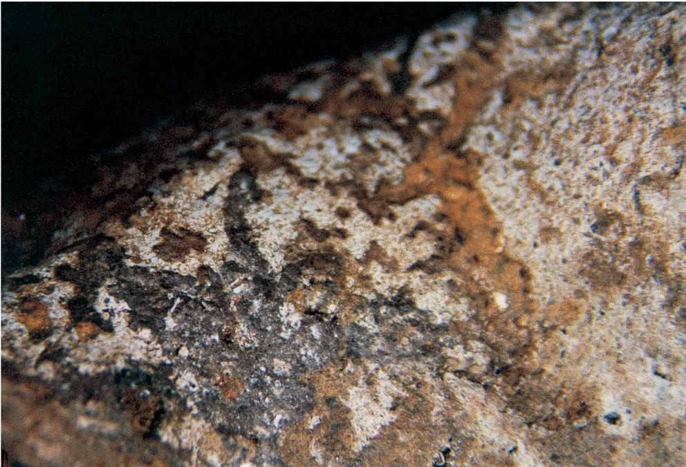
Abb. 34: Kupferfließspuren am Rand des Gusslöffels. Mehrfache Vergrößerung.
