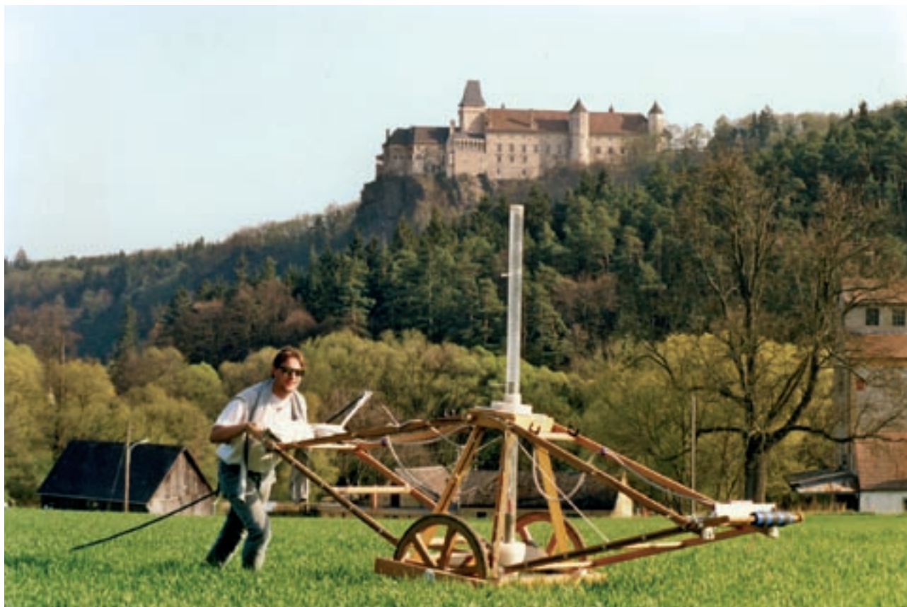
Abb. 16: Messwagen aus Holz und anderen nicht magnetischen Materialien mit einer Cäsium-Gradiometer Sensor Anordnung, die über ein Rohr mit Kardan Gelenk befestigt ist. Dadurch bleibt die vertikale Anordnung der beiden Sensoren während der geomagnetischen Messung weitgehend erhalten. Prospektionsmessung im Jahre 1994 im Bereich der Fundstelle der Kreisgrabenanlage Rosenburg. (Foto: P. Melichar)
