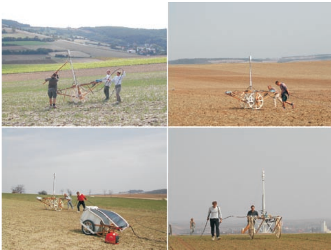
Abb. 30: Multisensor Cäsiumgradiometer im Messeinsatz. Das Messsystem wurde im Projektzeitraum mit fünf parallel arbeitenden Sensoren in Gradiometer-Anordnung eingesetzt. Vier Sensoren wurden auf einem unmagnetischen Messwagen mit automatischer Distanzmessung und Datenaufzeichnung in einer Höhe von 0.35 m über dem Boden verwendet. Der fünfte Sensor wurde in einer Höhe von 3.0 m über dem zweiten Sensor zur Korrektur der Variation des Erdmagnetfeldes verwendet. (Fotos: W. Neubauer)
