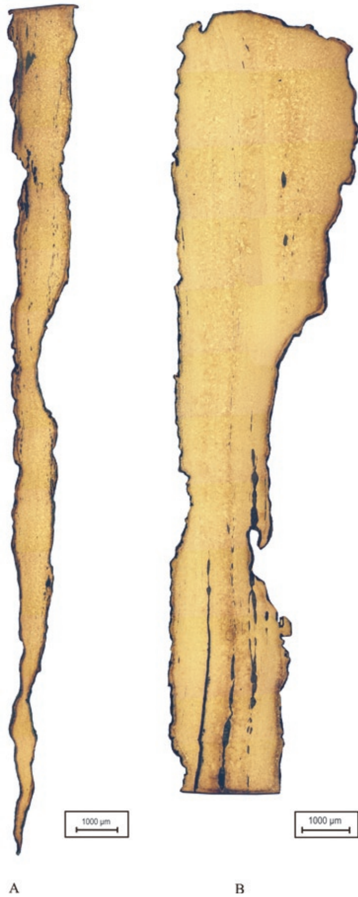
Tafel 4: Mannersdorf/Lgb. – Flur Reinthal Süd, Messer Fnr. 13/19, Ätzung mit Nital, A: Schneide, B: Rücken.
