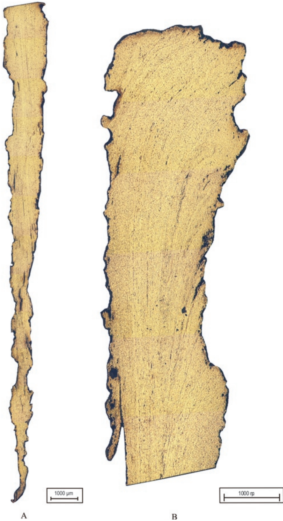
Tafel 7: Mannersdorf/Lgb. – Flur Reinthal Süd, Messer Fnr. 29/6, Ätzung mit Nital, A: Schneide, B: Rücken.
