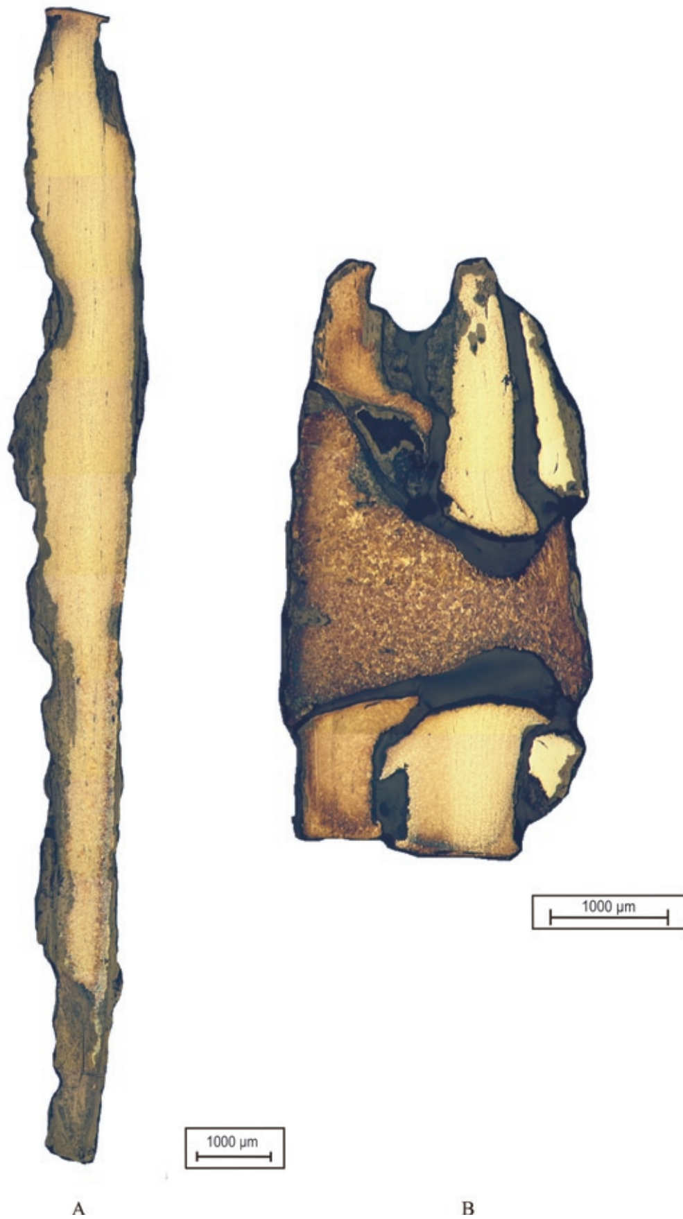
Tafel 1: Mannersdorf/Lgb. – Flur Reinthal Süd, Messer Fnr. 4/20, Ätzung mit Nital, A: Schneide, B: Niet.
