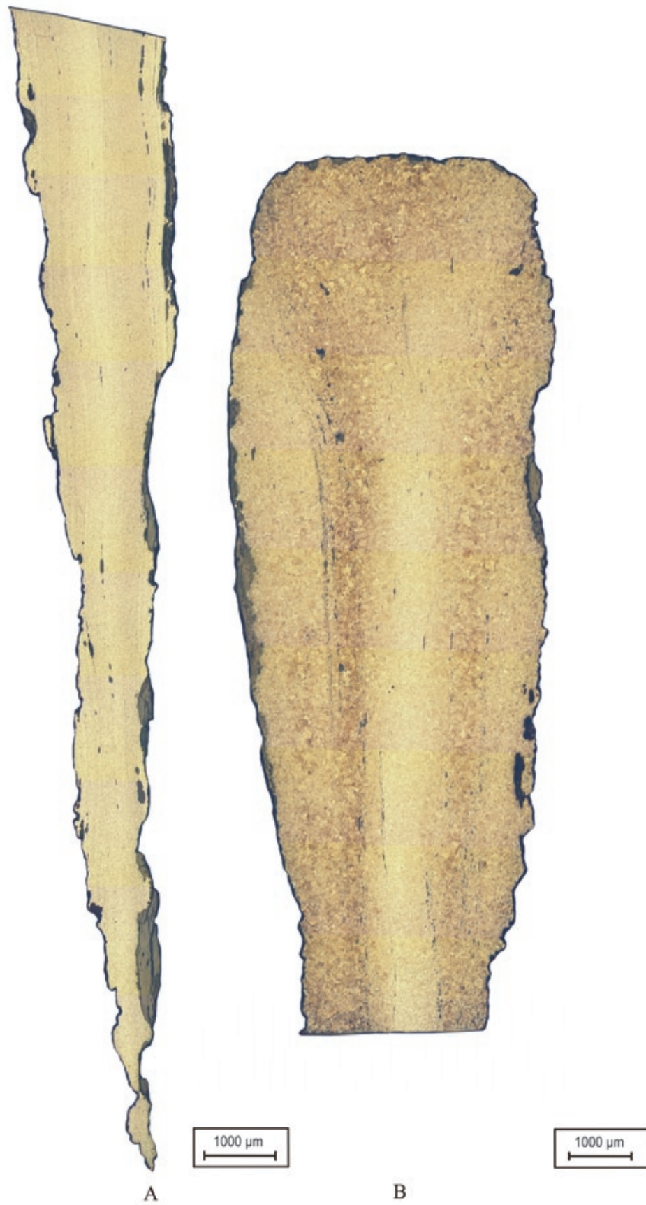
Tafel 18: Mannersdorf/Lgb. – Obere Kirchengasse, Messer 246, Ätzung mit Nital, A: Schneide, B: Rücken.
