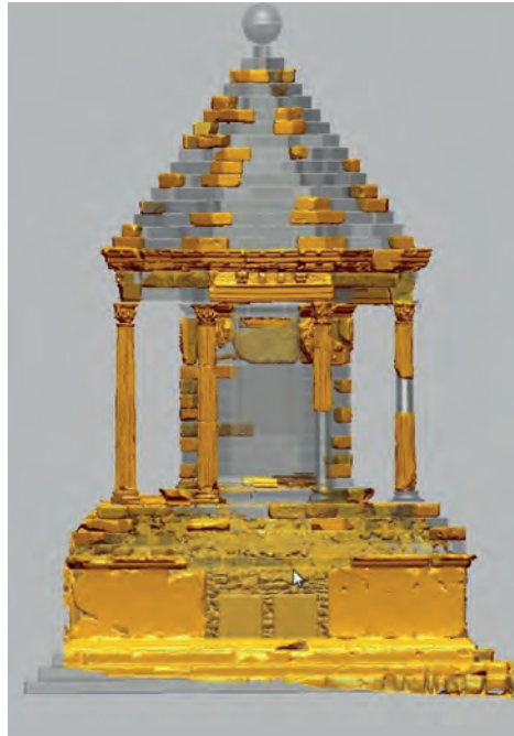
Abb. 17 b Oktogon, virtuelle Anastylose (Bauteile und Ergänzungen)
