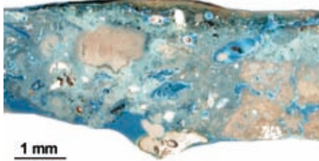
Abb. 19: Malgrund mit Kalkklümpchen in der Art einer opsis , darauf braun-ockerfarbene Malerei, vierte Malschicht im Stirnraum (Dünnschliff im Auflicht, mit blau eingefärbtem Harz getränkt).
