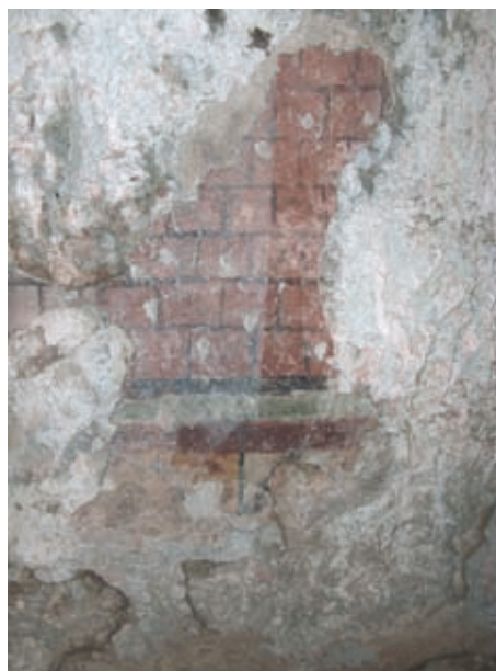
Abb. 29: Testfläche im Bereich der Paulusszene mit Hydrophobierung (rechts): die Behandlung führt zunächst zu einer deutlichen Farbver- tiefung, die sich jedoch nach einiger Zeit fast vollständig zurück entwickelt.
