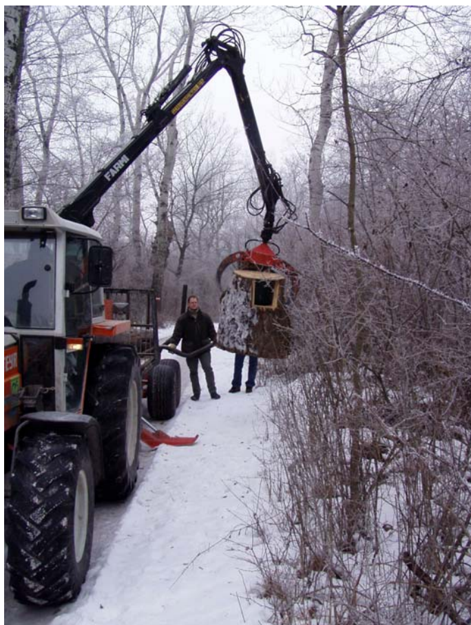
Foto 3-3: Aufstellung einer in einem Baumstamm integrierten Lichtschranke unter Mithilfe der MA49
