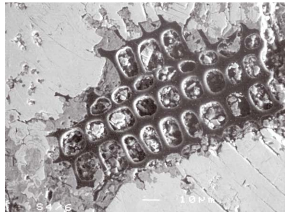
d) Detail von Bild (a): organisches Fragment (schwarz) mit „Zellstruktur“ als Einschluss in massivem Covellin. REM-Aufnahme, BE-Modus, Bildbreite 0,12 mm.
