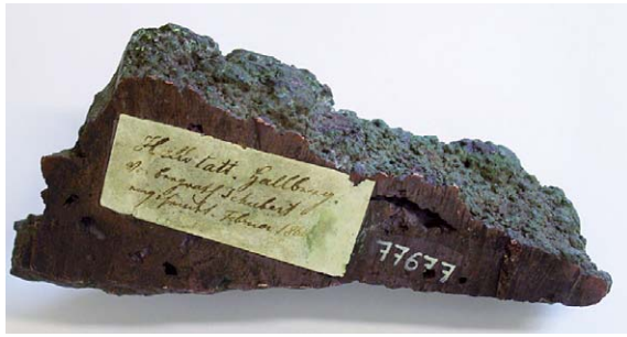
Abb. 32: Rohkupferschmelzkuchen (Grabungsfeld Salzberg, Hallstatt) mit geringmächtiger grüner Verwitterungsschicht (vorwiegend Malachit), ohne sulfidischer Reaktionsrinde, PA Inv.-Nr. 77.677; Fund von 1864.
