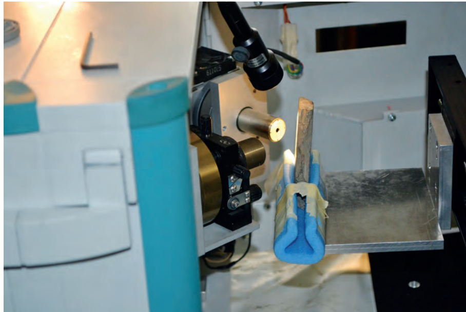
Abb. 5 Messung eines in einer Schaumstoffvorrichtung gesicherten Objekts mittels \mu -RFA
